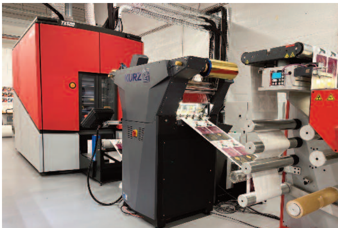
W POKAZANYM TUTAJ PROTOTYPIE MODUŁU DO WYKAŃCZANIA FIRMY KURZ NA PODŁOŻE DRUKOWE NAKŁADANA JEST FOLIA DO WYKOŃCZEŃ ŹRÓDŁO: XEIKON
